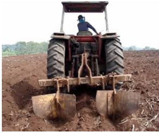
Gambar 14. Proses Pembuatan Kairan dengan menggunakan Furrower
